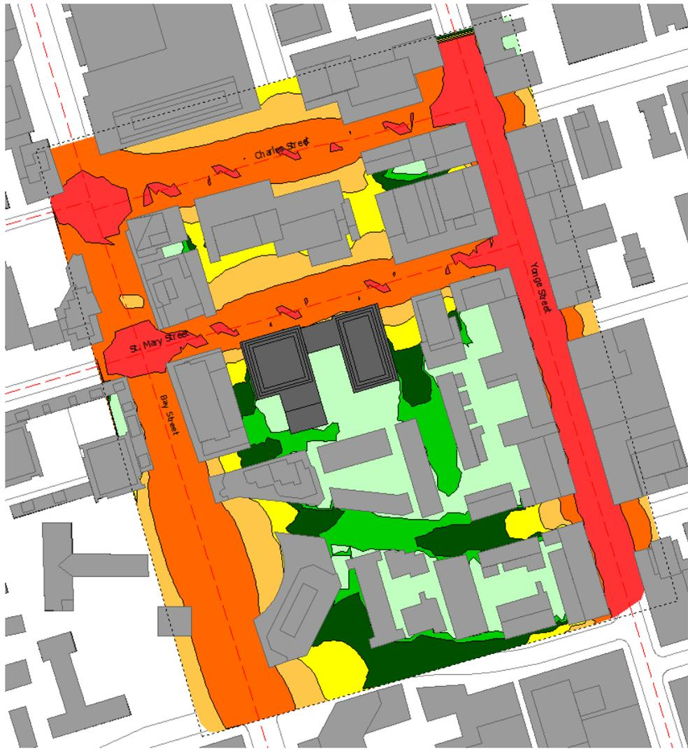
**FIGURE 4: NIGHTTIME NOISE CONTOURS (4.5 M ABOVE GRADE)**
